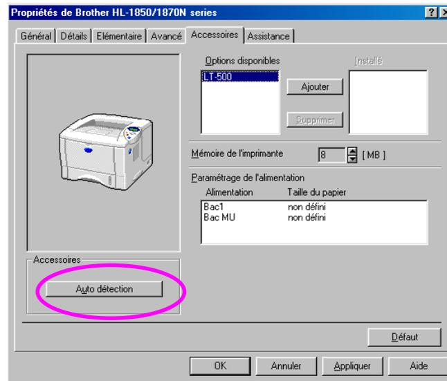
6. Sélectionnez la taille du papier, le type de support et la source d'alimentation dans l'onglet Propriétés du pilote d'imprimante.
