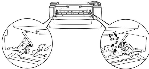
☞ 3. Nettoyez le fil corona primaire à l'intérieur de l'ensemble tambour en faisant délicatement coulisser la languette bleue à plusieurs reprises d'une extrémité à l'autre. Ramenez la languette à sa position d'origine (▲) avant de remettre le tambour dans l'imprimante.
